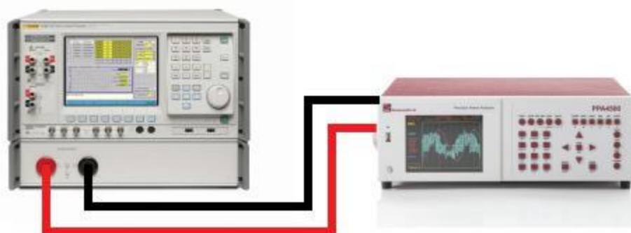
Рисунок 4. Пример процесса калибровки анализатора ПРИЗМА-450 с помощью Fluke 6105A
